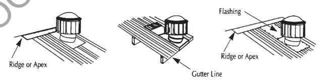
Dektite pipe flashing
